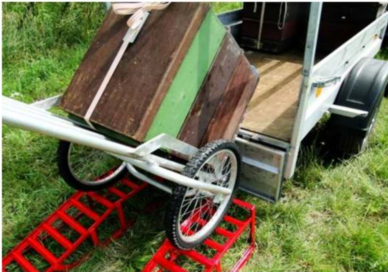
Karre mit Beute kippen (feste Ladeschaufel=kurzer Hebel)
