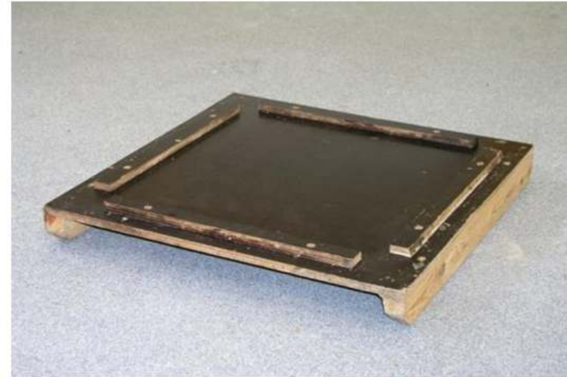
Transportboden für Zargen erspart umstapeln
