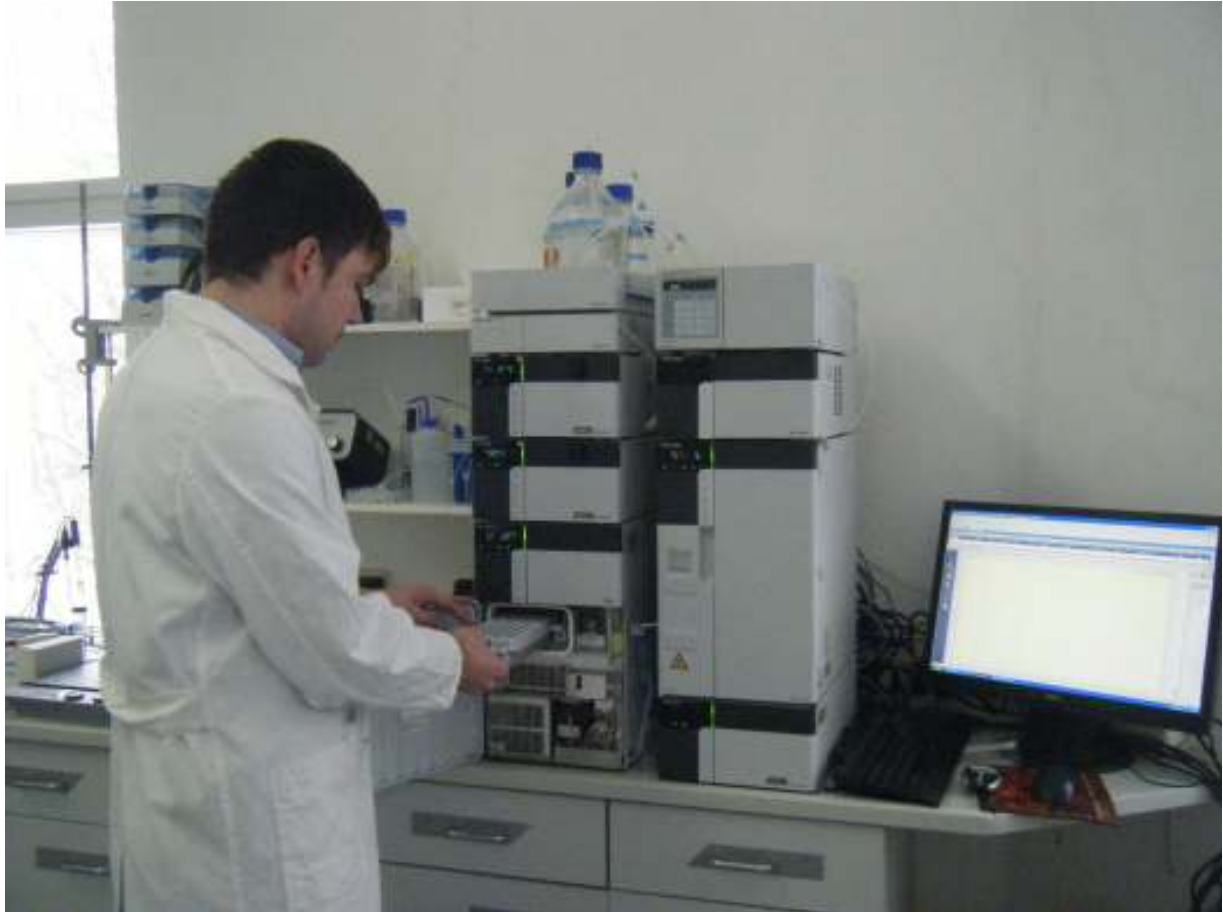
Abbildung 7: Diplomand Marcus Danne beschickt die neue HPLC-Anlage (EFRE-Mittel) zur Bestimmung von HMF in Honigproben.
